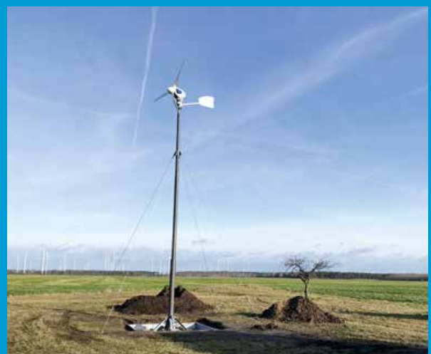
Abb.: Prototyp der Mini-Windkraftanlage von Fraunhofer IAP, BTU und EAB [Quelle: Fraunhofer IAP]
