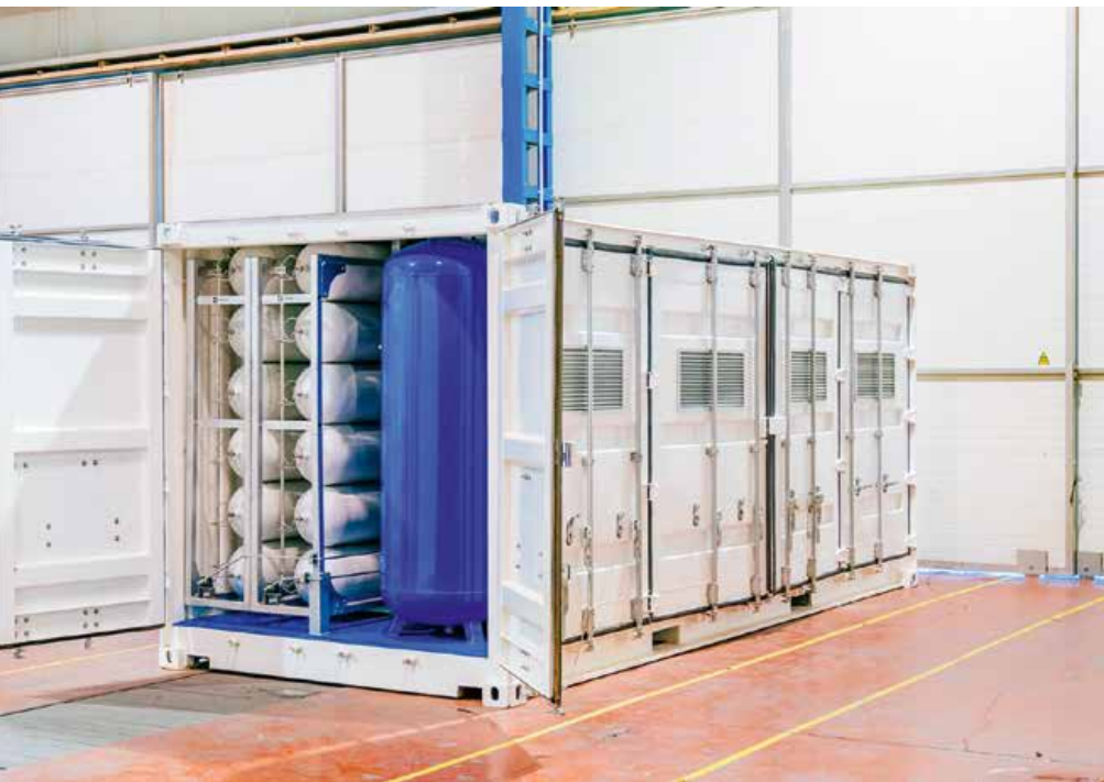
Abb. 1: Die Calvera Industrial Group baut in Spanien spezielle Betankungsstationen, die täglich 120 BZ-Gabelstapler versorgen können [Quelle: Calvera]
