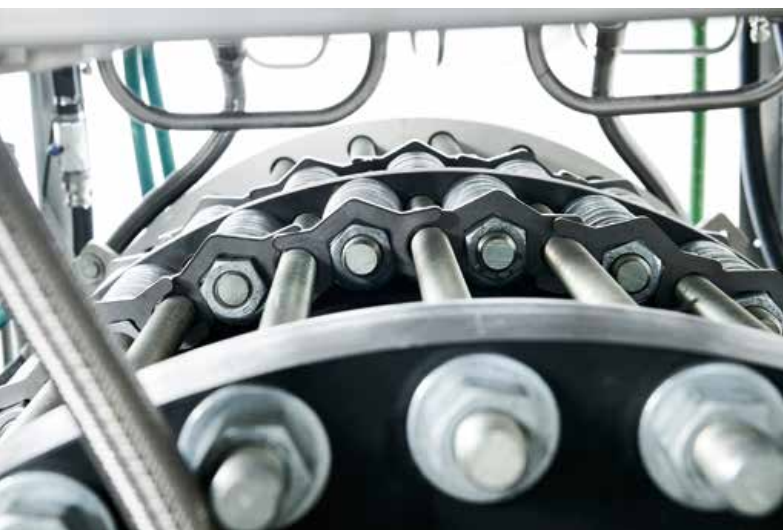
Abb. 1: Verschraubungen am Elektrolyseur-Stack [Quelle: Green Hydrogen Systems]
