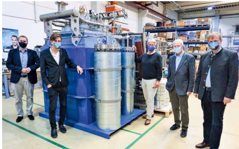
Abb. 3: Firmengründer Andy Gradel (2. v. l.) präsentiert eine schlüsselfertige Anlage zur Dampfreformierung von Biogas [Foto: BtX Energy]
