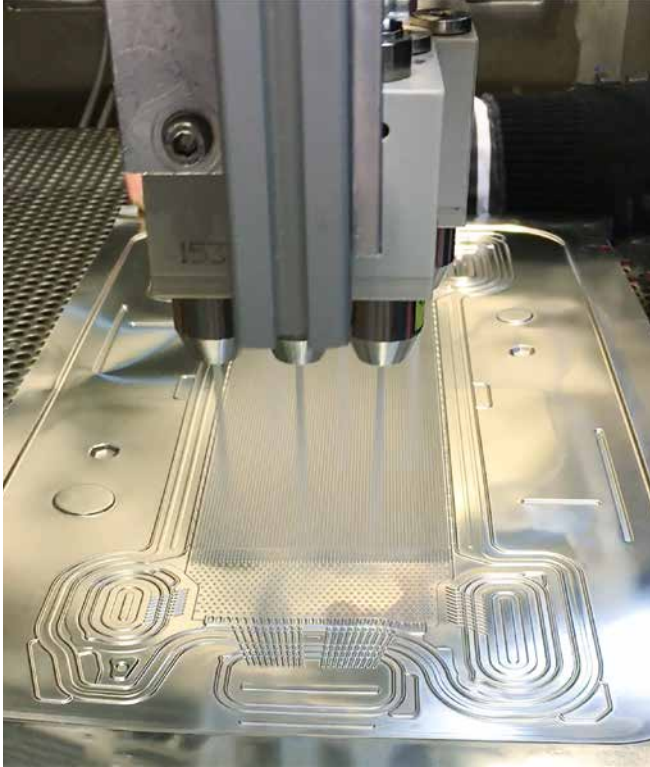
Abb. 1: Durch die Ausstattung mit mehreren Düsen lässt sich mit der CO 2 -Schneestrahlreinigung die gesamte Oberfläche von Bipolarplatten zügig und mit einem guten Ergebnis reinigen
