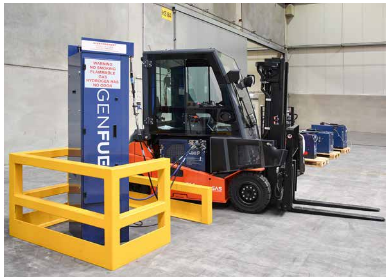
Abb. 5: BZ-Gabelstapler mit Plug-Stack inside an der H 2 -Station
