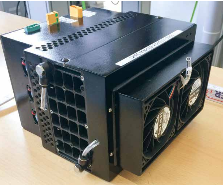
Abb. 3: Kompaktes BZ-System mit 1.000 W Dauerleistung. Rechts im Bild sind die Ventilatoren für die Luftkühlung zu sehen. Der Schlauch zwischen den Ventilatoren dient zum Purgen mit Stickstoff. [Quelle: DHBW Mannheim]
