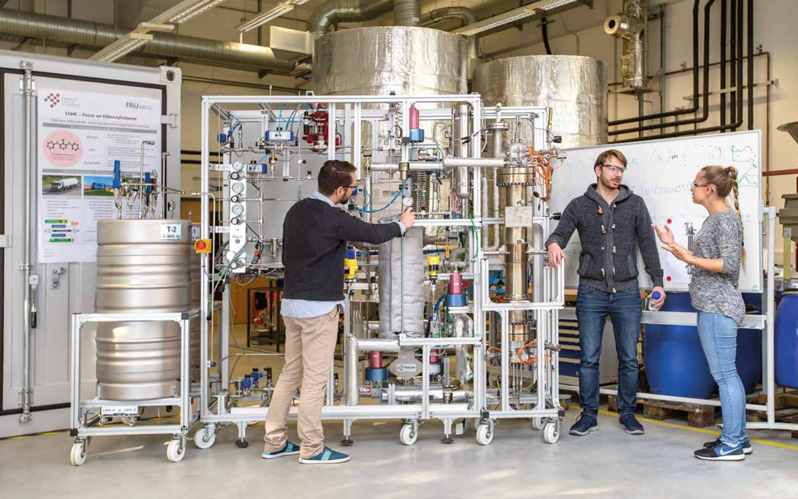
18 Abb. 1: Der LOHC-One-Reaktor auf dem Energie Campus Nürnberg, der für eine effiziente Wasserstoffspeicherung konzipiert wurde, befindet sich noch im Aufbau
