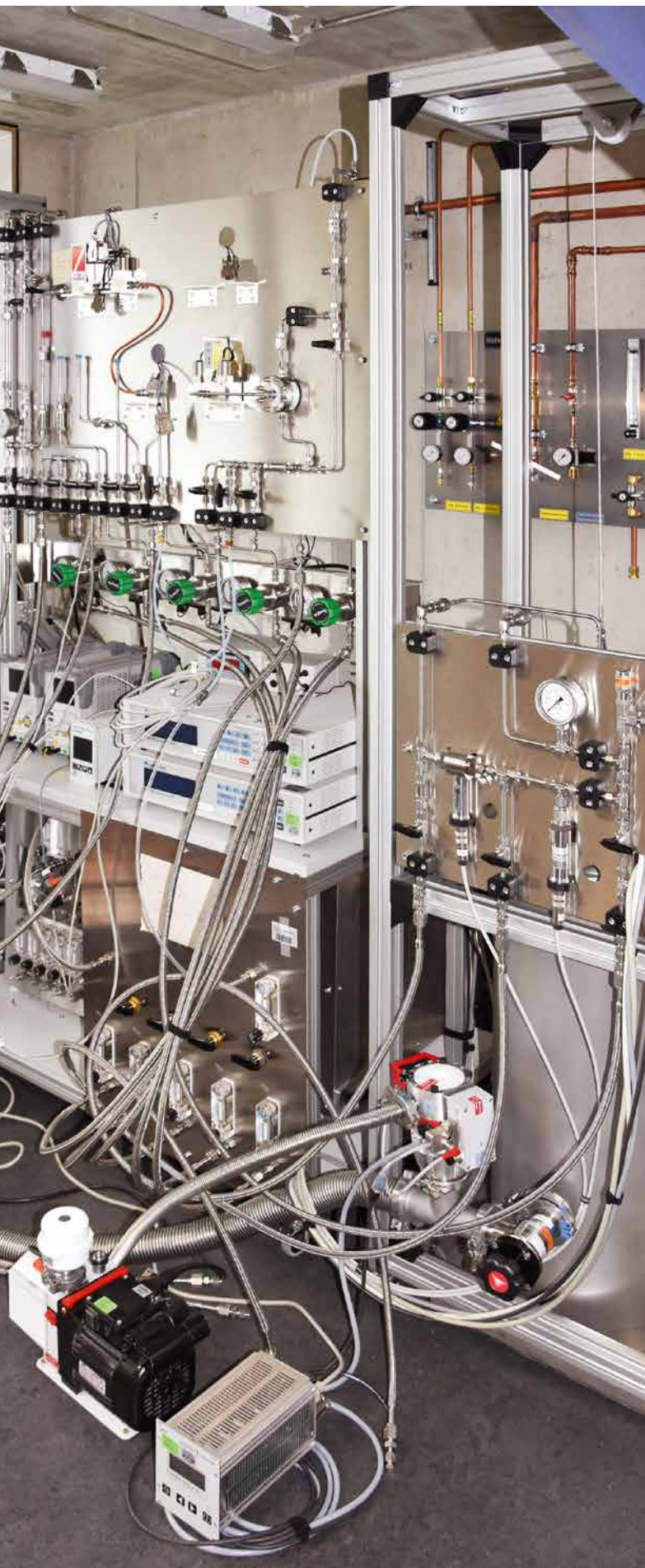
Abb. 2: Präzisionsprüfstand von Sebastian Eisenhuth zur Ermittlung des Konzentrationsverhältnisses von Ortho- und Para-Wasserstoff
