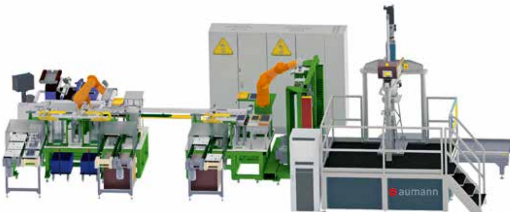
Abb. 2: Anlage zur automatisierten BZ-Stack-Montage
