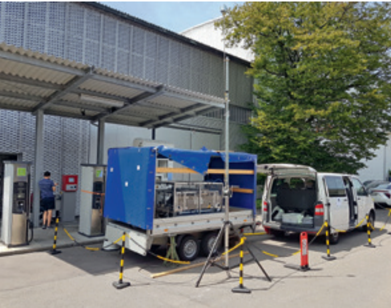
Abb. 1: H 2 -Prüfstandard (Hydrogen Field-Testing Standard - HFTS) auf einem Anhänger und in Betrieb an der Empa-Wasserstofftankstelle [Quelle: Metas]
