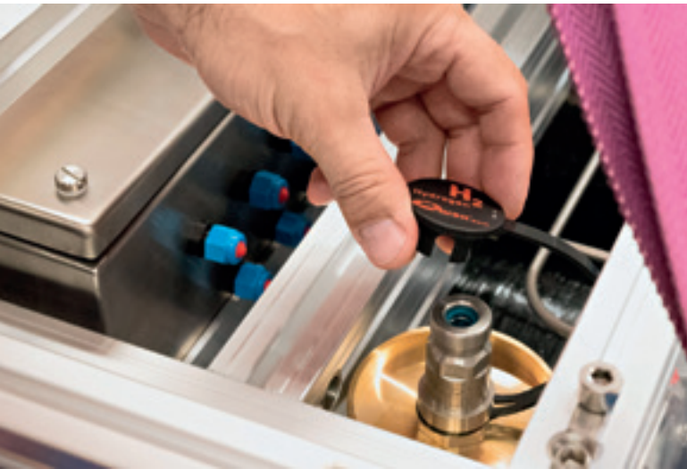
Abb. 2: Der HFTS besitzt einen Tankstutzen wie ein normales Wasserstofffahrzeug. Die Betankungsdauer ist mit der eines Fahrzeugs vergleichbar. [Quelle: Meta]
