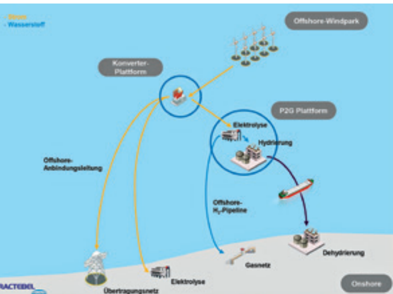
Abb. 3: Prinzipskizze der Windparkanbindung [Quelle: Tractebel]
