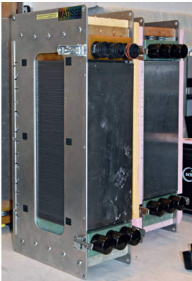
Abb. 2: PEM-Stacks mit Seitenblechen und Federn zur Verpressung
